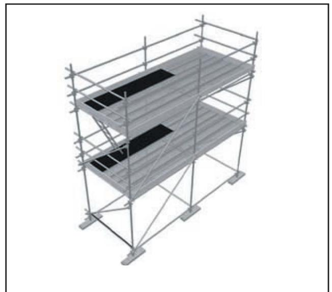
Figura 53. Ejemplo de andamio metálico tubular no modular
