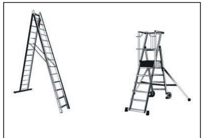
Figura 38. Ejemplos de escaleras con estabilizadores
