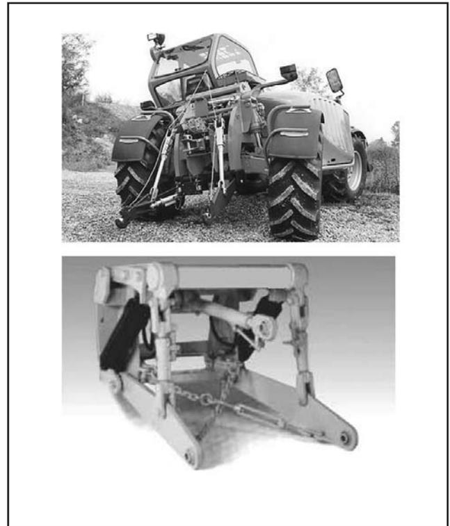
Figura 10. Sistema de enganche en tres puntos
