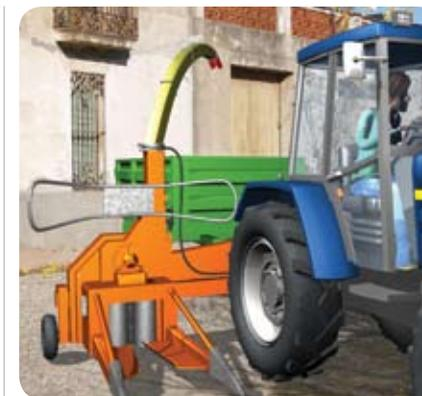
Si vuestra máquina es una máquina autopropulsada, velad por el buen mantenimiento del sistema de frenado y cumplid las normas de circulación cuando circuléis por vías públicas
